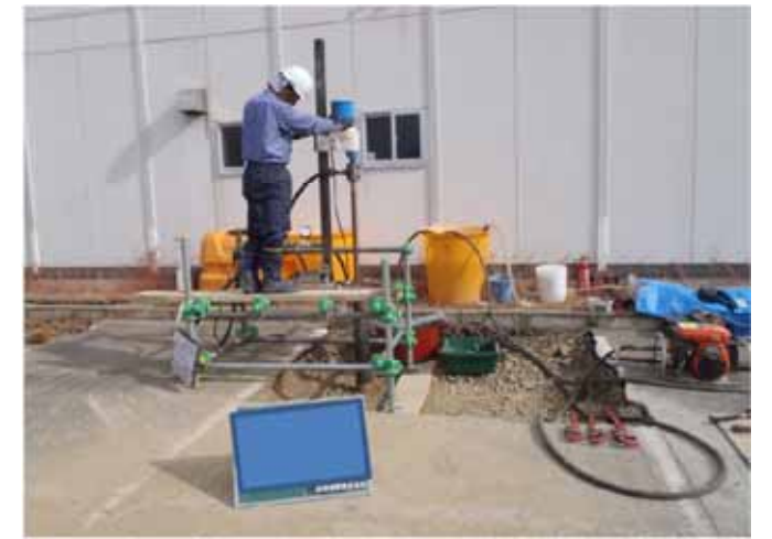
図3 コアドリルを用いた試料採取状況 (事例)
