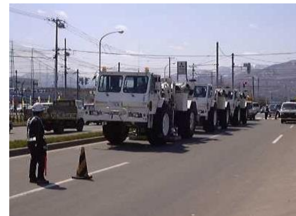
図3 起振車による発振状況(事例)
