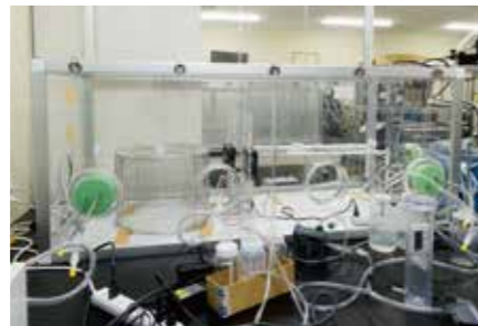
放射性ガス・エアロゾル用標準曝露システム 放射性ガスとエアロゾルの両方を制御可能な日本唯一のシステムです。呼吸による内部被ばくの環境を模擬することができます。
