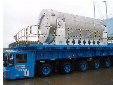
専用輸送車両(むつ小川原港→受入れ・貯蔵施設)
