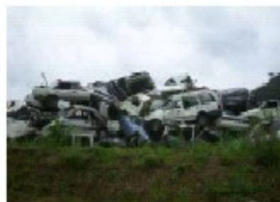
〔乱雑で不適正な積み方の例〕
