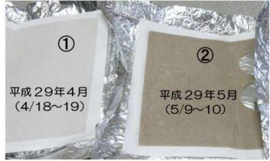
図 4 ハイポリウム石英繊維ろ紙に捕集された粉じん
