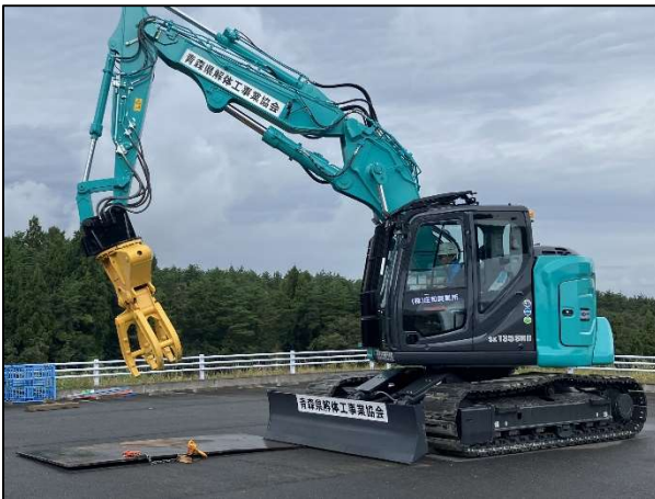
図4 バックホウ、敷き鉄板の準備
