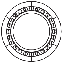
断面a-a鉄筋配置図
