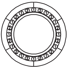
断面 a-a鉄筋配置図
