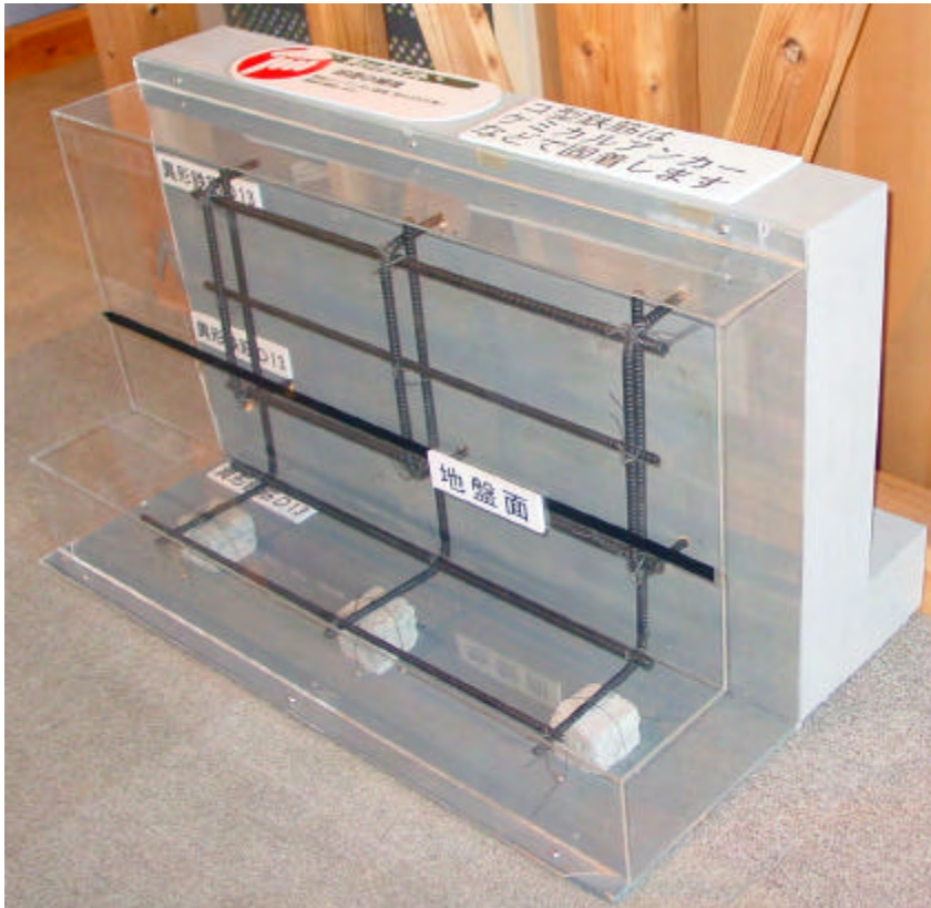
基礎の打ち増し模型
