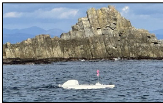
深淺測量状況（GNSSソナー搭載無人ボート）
