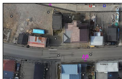
現地測量成果と簡易オルソ画像成果の重ね合わせ（一部拡大）
