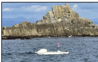
深浅測量状況（GNSSソナー搭載無人ボート）
