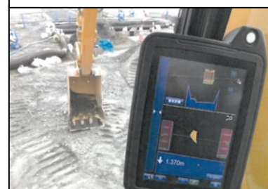
インテリジェントマシンコントロールで操作をセミオート化
