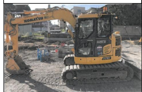
インテリジェントマシンコントロールで操作をセミオート化
