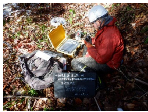
弾性波探査測定状況
