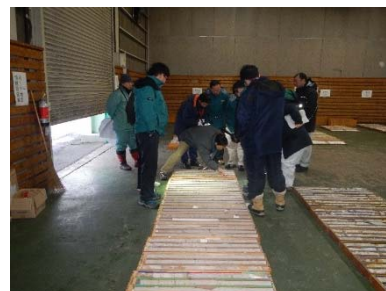
ボーリングコアの観察状況
