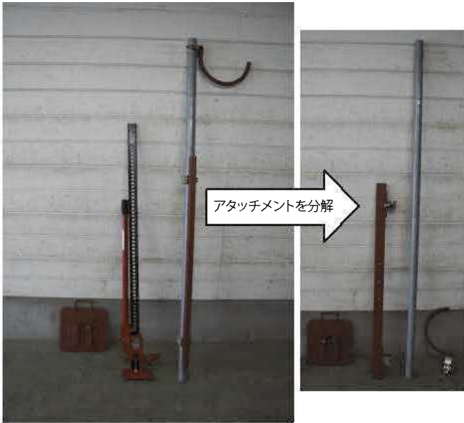
図1 ハイリフトジャッキ(中央)とアタッチメント
