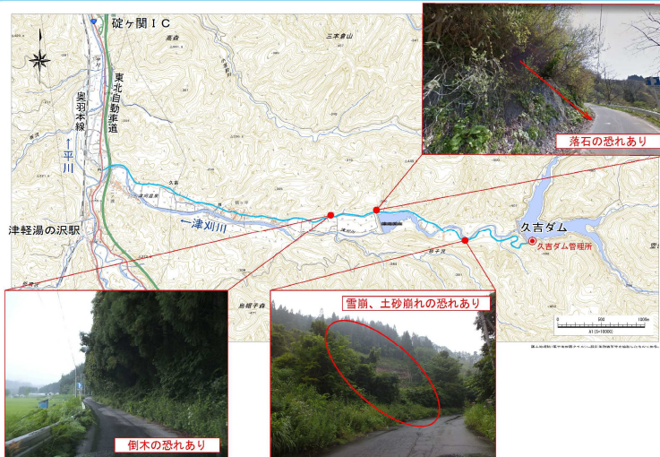
ダムへのアクセス道路の危険箇所
