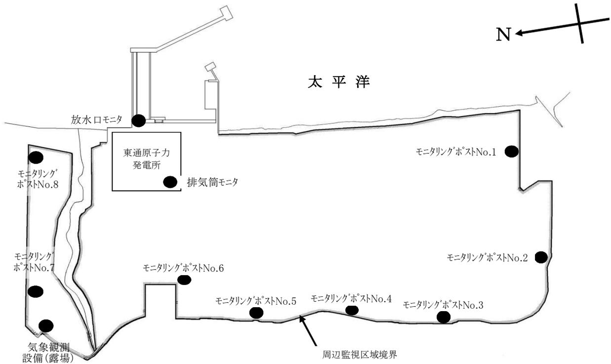
図 モニタリングポスト、排気筒モニタ、放水口モニタ及び気象観測設備配置図
