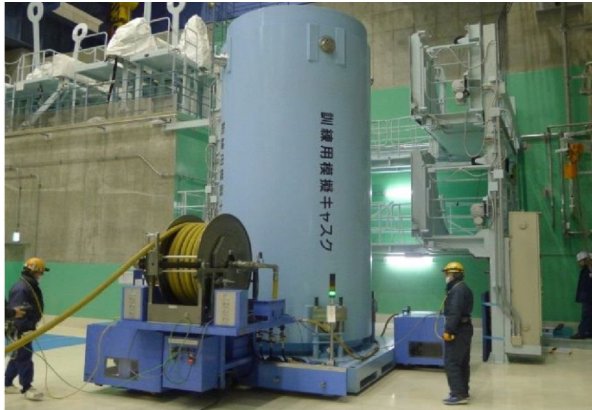
搬送台車を用いた模擬金属キャスクの移送
