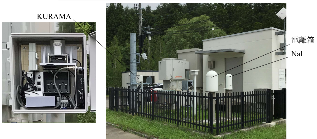
図 2 モニタリングポスト砂子又局に設置した測定器の位置関係
