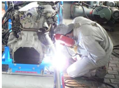
発電用モーターの取付 (溶接)
