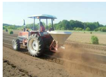
水分が少ないため堆肥は ブロードキャスタで散布可能
