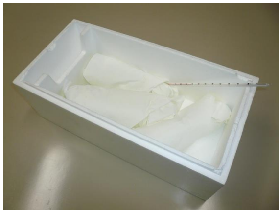
発泡スチロール容器に温湯ペットボトルを入れ加温する。(温度計で確認)
