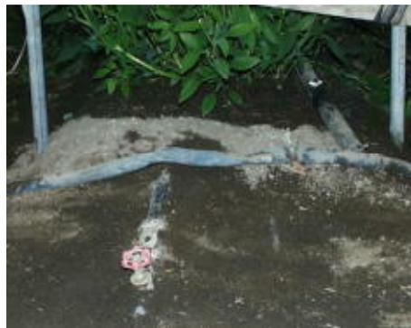
チラー(左写真)で冷却された水を、各畦の地下15～20cmに埋設されたパイプ(上写真)に送って循環させる。
