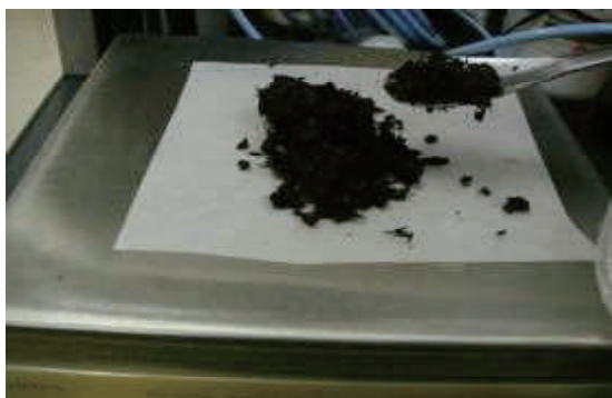
①生堆肥10gを測定し、ポリ瓶に移す
