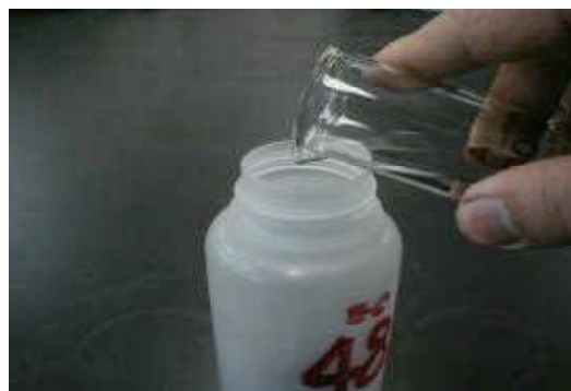
②0.5M塩酸100ml(カリ分析は蒸留水)を加える
