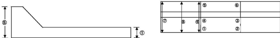
天端高又は厚さは、天端面とパラペット頂部を別々に管理します。また、パラペットがないフラット断面の上部工については天端面と同様の扱いとします。
