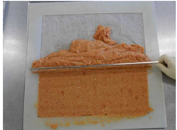
④ 成形 (本試作では剥離性のよいテフロン製のものを使用)
