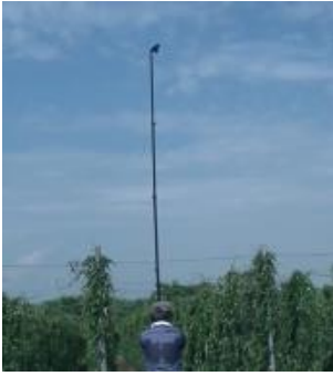
写真 1-1 4m 斜め下方撮影風景
