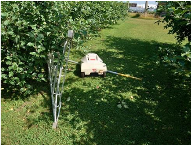
図9 KRONOS MR-300 が脚立を倒しエラー停止した状態
