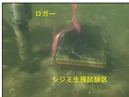
【湖底から30cm地点に設置したロガーとシジミを収容した容器】
