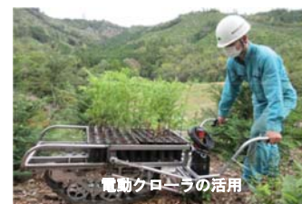
電動クローラの活用 松くい虫被害対策における 労働負担の軽減
