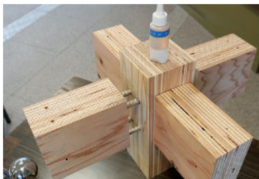
ラーメン構造を解説する展示。（2024年6月の構造躯体見学会にて）
