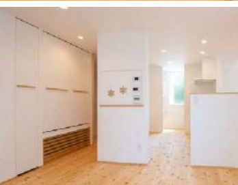
写真右上は、玄関とキッチンを繋ぐ室内窓。写真左下の木製スリットは、床下エアコンの空調用。ダイニングや洗面室、ランドリールームにもこだわりが詰まっている。
