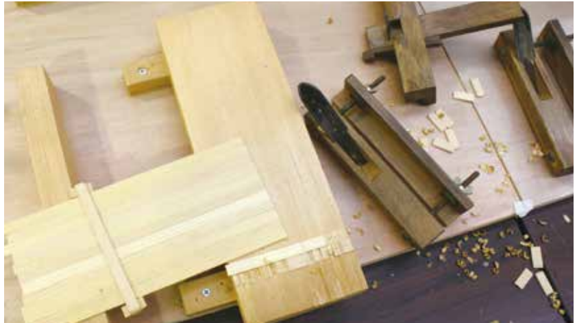
細いヒバの板を切り、組み合わせて美しい模様を創り出す
