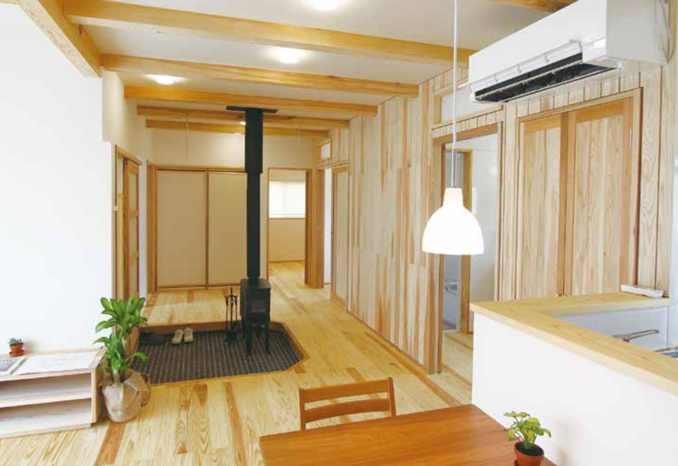
薪ストーブ1台で家中の暖房をまかなっている
