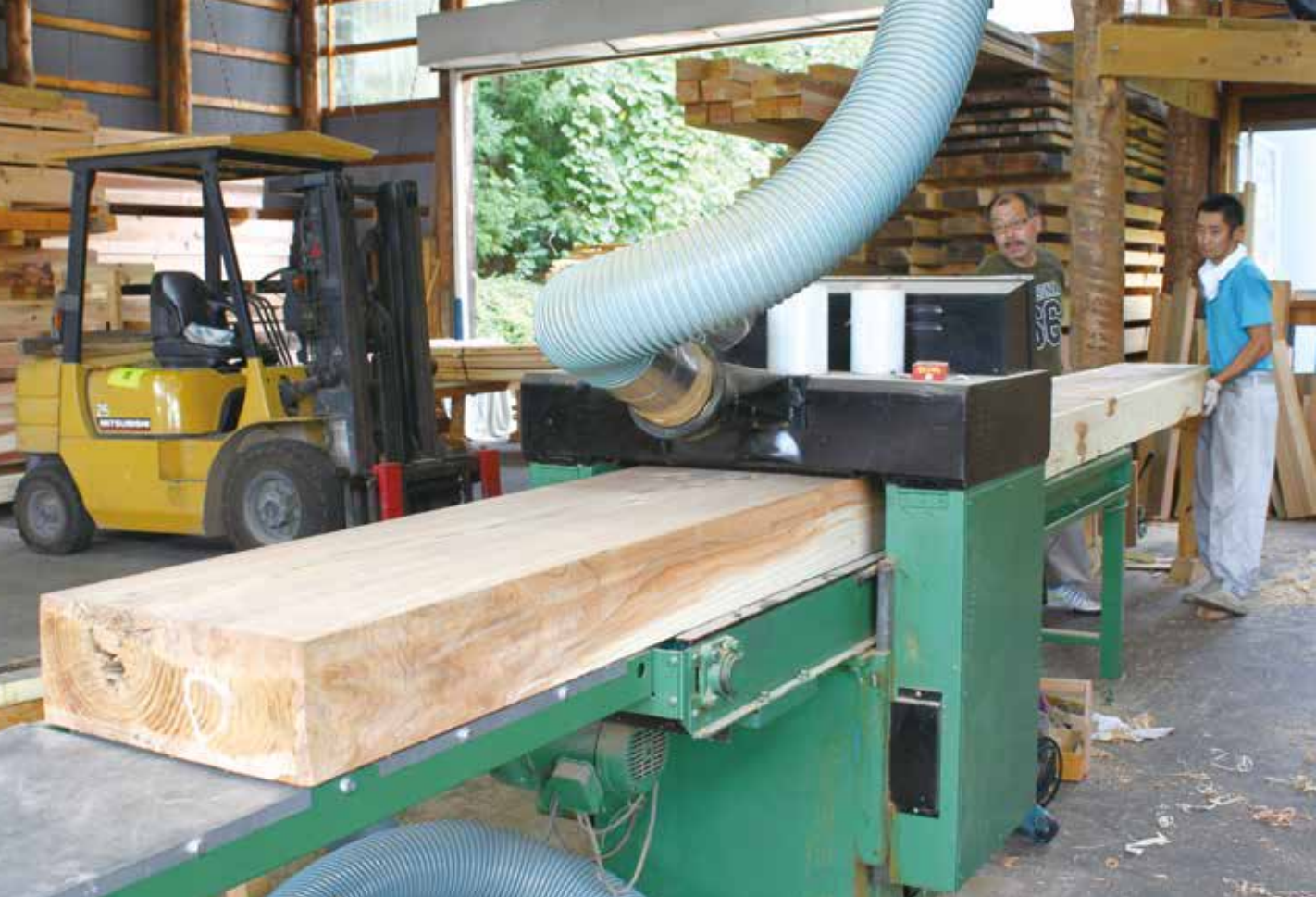
梁に使うスギの長尺物を機械カンナのプレーナーにかける。一般に他社では現場に使う木材は木材店に発注して取り寄せるが、ボックスは自社の加工場で加工する
