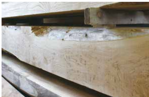
10年間乾燥させた100年もののクリが大黒柱になる
