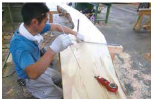
アカマツの曲がりの加工をする大西洋平さん。宮大工の技で木の味を引き出す
