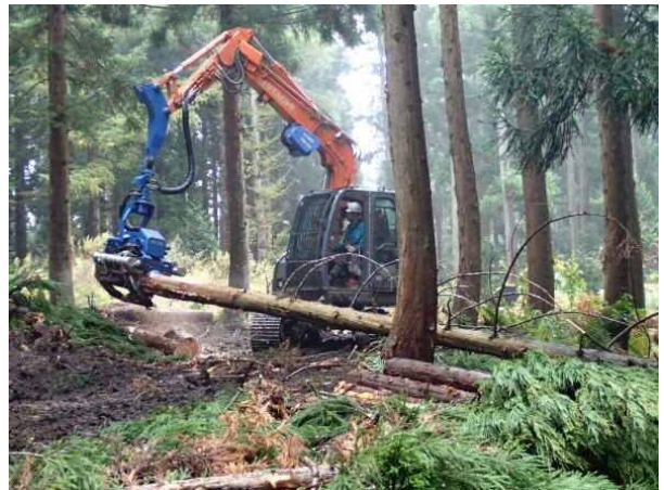
ハーベスタによる伐倒・枝払・玉切（処理時間：約2分半／本、弘前森組）
