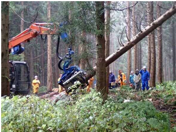
ハーベスタによる伐倒・枝払・玉切（処理時間：約2分半／本、弘前森組）
