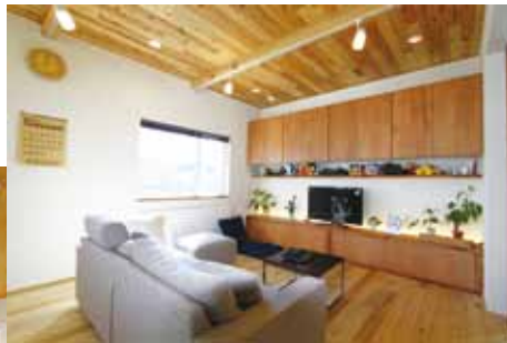
空気層の多いスギを床材に使い冷暖房負荷を下げている
