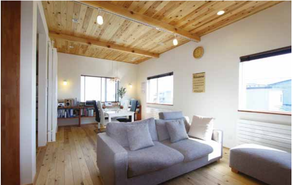
空気層の多いスギを床材に使い冷暖房負荷を下げている
