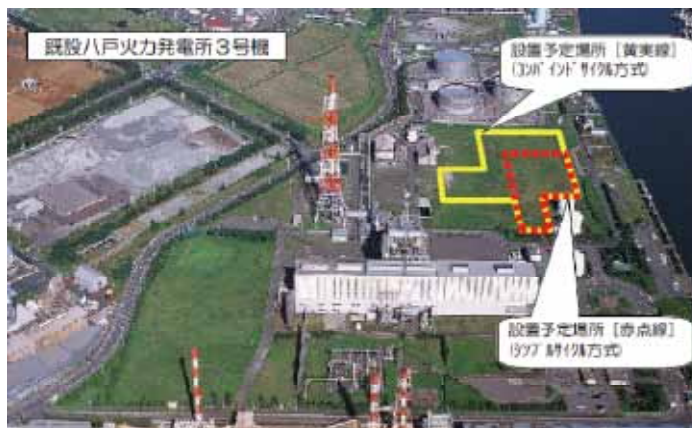
図3-16 八戸火力発電所構内配置
