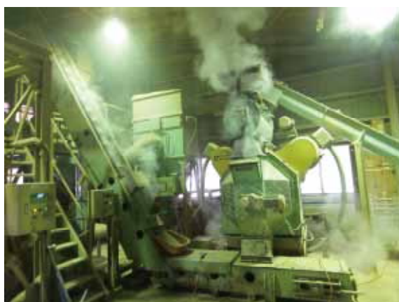
原料を乾燥させた後、熱と圧力をかけてペレットを製造
