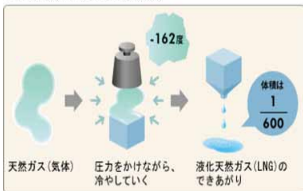
図 3-3 天然ガスの液化フロー
